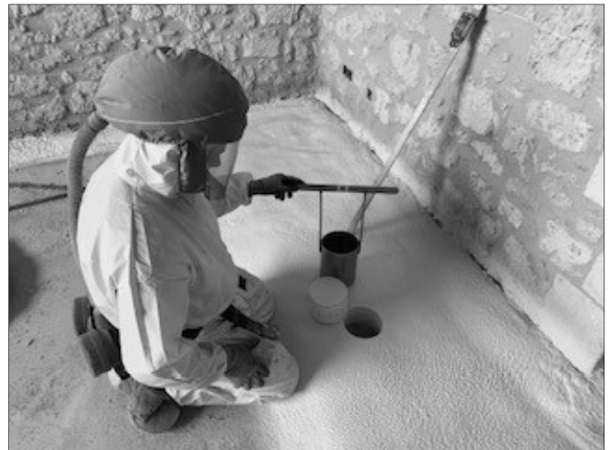
Figure 1 : Prélèvement des éprouvettes par carottage
